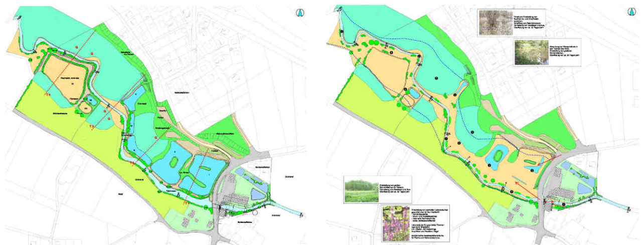
Bild 3: links: Biotoptypen Bestand, rechts: Entwicklungsziele (ockerfarben = Ausuferungsbereiche)
